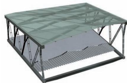
La passerelle sera dotée d'une structure métallique et d'une couverture translucide.
